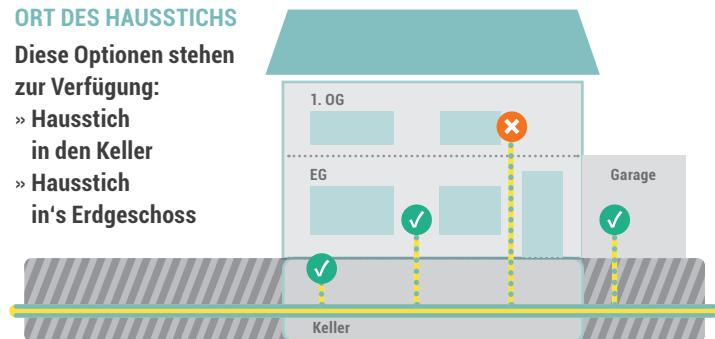
Der Hausanschluss leitet die Glasfaser durch die Außenmauer ins Haus. Idealerweise liegt er nahe am Modem-Standort, um lange Kabelwege zu minimieren und eine optimale Internetverteilung im Haus zu sichern. Nach dem Hausstich geht es im Haus mit der Glasfaser-Dose und der Positionierung des Modems bzw. Routers weiter. Dabei bieten wir Ihnen die zwei folgenden Möglichkeiten:
