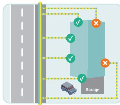
Vom Hauptkabel im Gehweg bis zum Hausanschluss nutzen wir verschiedene Bautechniken. Je nach lokalen Gegebenheiten setzen wir entweder klassische Baggerarbeiten oder eine Erdrakete ein.
