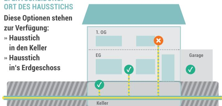
Der Hausanschluss leitet die Glasfaser durch die Außenmauer ins Haus. Idealerweise liegt er nahe am Modemstandort, um lange Kabelwege zu minimieren und eine optimale Internetverteilung im Haus zu sichern. Nach dem Hausstich geht es im Haus mit der Glasfaser-Dose und der Positionierung des Glasfaser-Modems weiter. Dabei bieten wir Ihnen die zwei folgenden Möglichkeiten:
